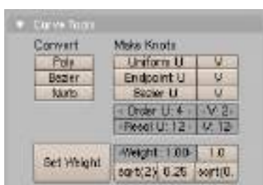
Fig. 2.15: Parâmetros de controle de uma curva NURBS .
